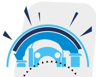
Especialmente importante es el mantenimiento de las **zapatas** que, junto con el **tambor**, realizan todo el **esfuerzo de frenado**, y especialmente en el **freno de estacionamiento**. El material de fricción de las zapatas debe cumplir con el **Reglamento 90** vigente en toda Europa.
